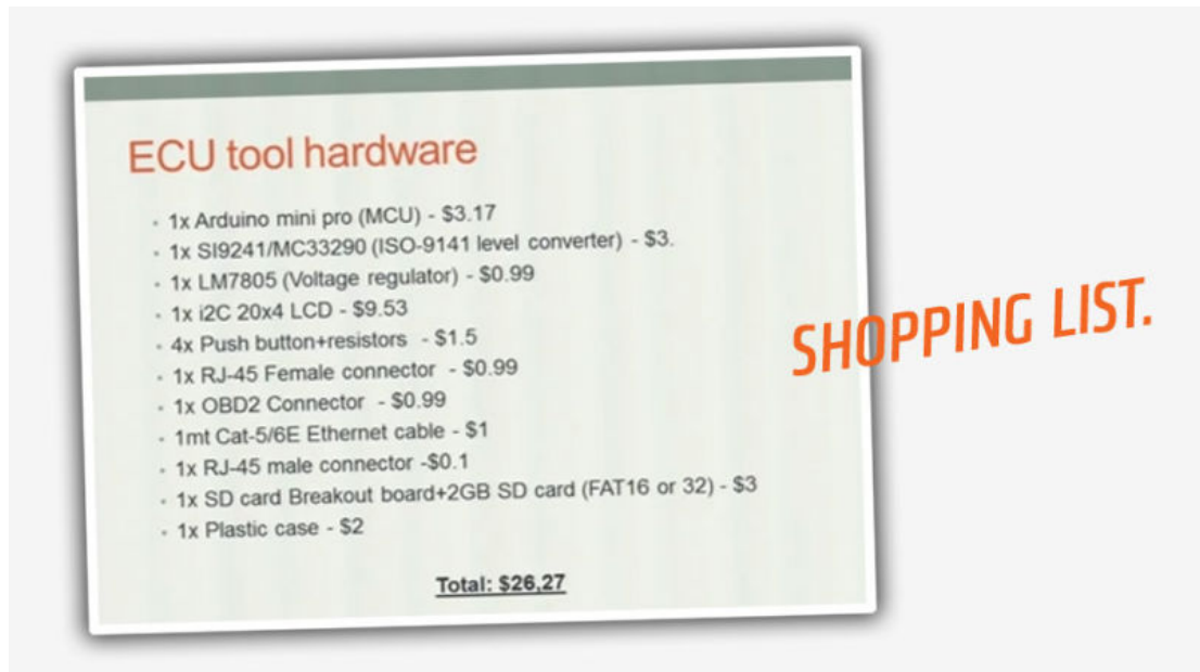
Figura 1: Materiales para elaborar la herramienta con la cual hackear el vehículo.[32]
