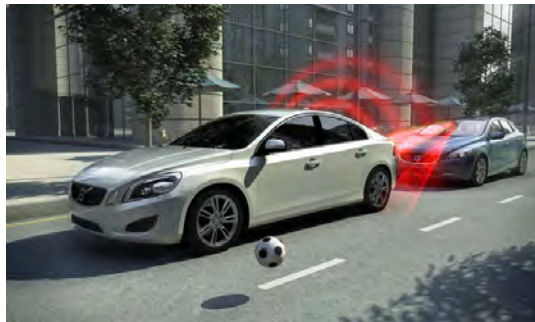
Figura 17. Volvo City Safety. Su capacidad de análisis y reacción pretenden evitar que, la falta de respuesta por parte del conductor ante una frenazo del vehículo anterior, desemboque en un accidente con secuelas físicas para los conductores.
