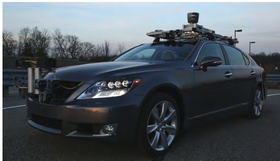
Figura 14. Toyota ha utilizado un Lexus LS 600h para equiparlo con un computador y los diferentes sistemas de detección que permiten la conducción autónoma.
