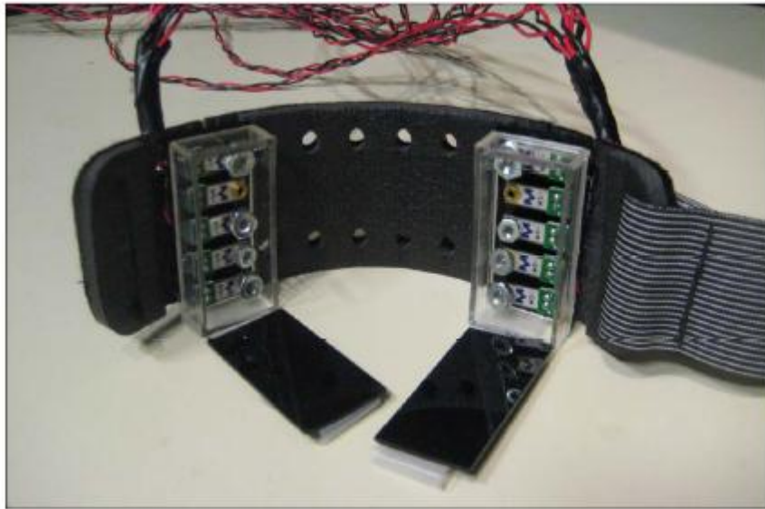
Figura 1. Brazalette. Los elementos sensores detectan las vibraciones través del cuerpo. Los dos paquetes de cinco sensores se muestran.
