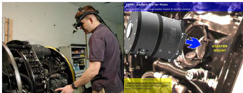
Fig. 17. Instalación de un nuevo motor de arranque.
