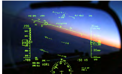
Fig. 22. Aplicacion de Head Up Display dentro de un avión de combate.
