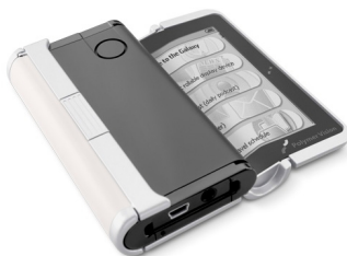
Figura 1. Raedius: Prototipo de teléfono celular enrollable de Polymer Vision
