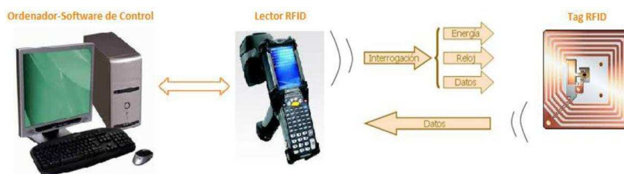
Figura 1. Funcionamiento del sistema RFID [7].
