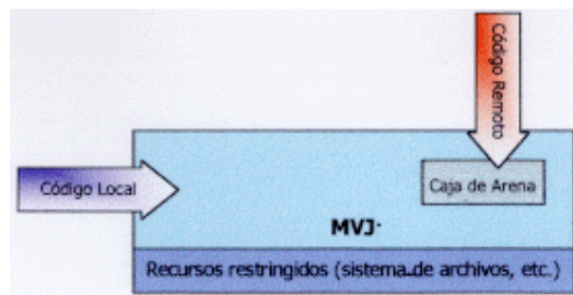
Figura 4. Modelo de seguridad del JDK 1.0.
