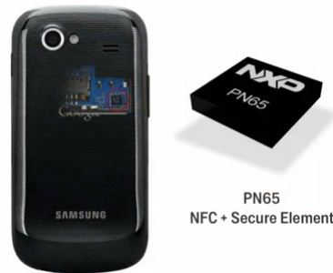
Fig. 4. Chip NXP encargado del resguardo de la información.
