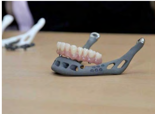
Figura 9: Ejemplo de una mandíbula fabricada a medida con una impresora 3D.
