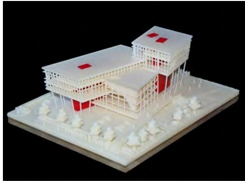
Figura 7: Maqueta fabricada con el proceso aditivo
